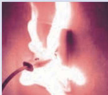
【通電後に発生したトラッキング現象】
