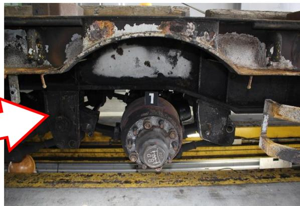
制動装置及びタイヤが焼損
