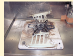
こんろに水切りカゴが乗った状態で点火した火災事例
