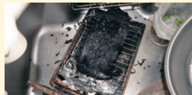
グリル内にキッチンペーパーが入った状態でこんろとグリルのスイッチを間違えて、グリルに点火した火災事例
