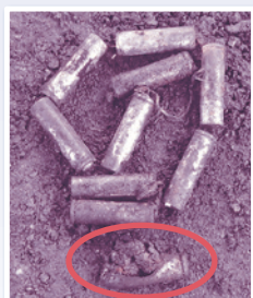
内部が破裂したリチウムイオン電池
