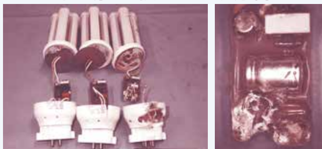
(左) 焼損したコンパクト形LEDランプ、(右) 焼損した電源装置
