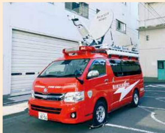
衛星アンテナなどを使って、消防隊の活動を補助します。
